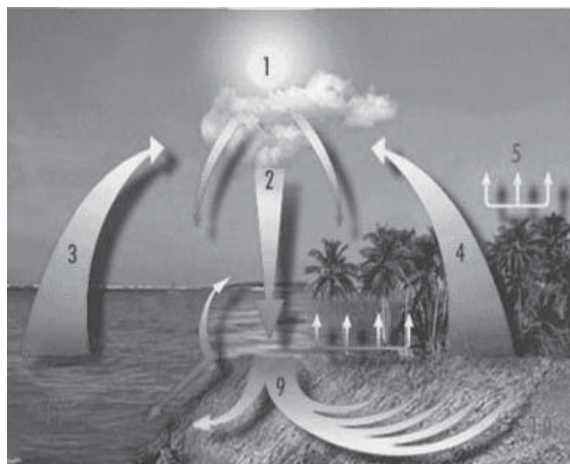
1 - Күн энергиясы, 2 - жауын-шашын, 3 - мұхит бетінен булану, 4 - өсімдіктер арқылы булану, 5 - ағаш қроналарының ылғалды ұстап қалуы, 6 - топырақ бетінен ылғалдың булануы, 7 - беткі ағын суларының булануы, 8 - мұхитқа құятын беткі ағын, 9 - жерасты ағыны, 10 - топырақ қабаты, 11 - мұхит беткі бөлігі 119-сурет. Дүниежүзілік су айналымының сызбасы
