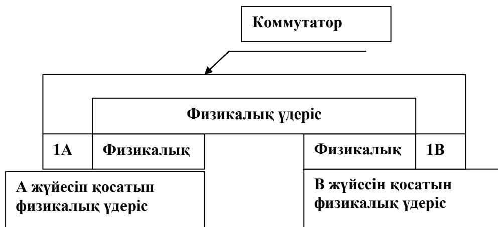
41-сурет – Коммутаторлар құрылымы
