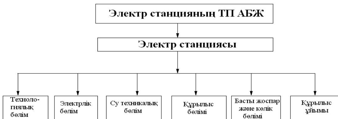
8.2.1-сурет. Жобалау кезіндегі электр станцияның құрылымы.
