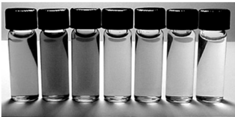
6.10-сурет. Әртүрлі өлшемдегі наноқабықшалары бар түтікшелер (Дженифер Уэст)
