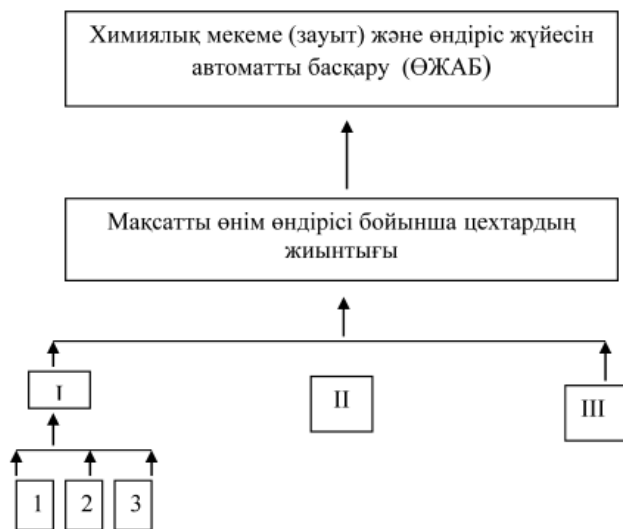
4-сурет. Химиялық өндірістің құрылымы: 1, 2, 3 – типтік химиялық-технологиялық үдеріс I, II, III – технологиялық цехтары ӨЖАБ (технологиялық үдерістің) бөлімдері
