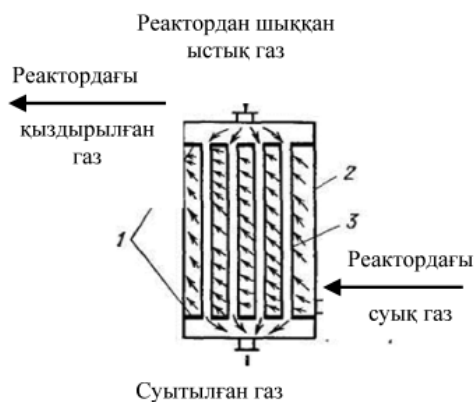
33-сурет. Рекуператор. 1 – плиталар, 2 – аппарат корпусы, 3 – түтікше
