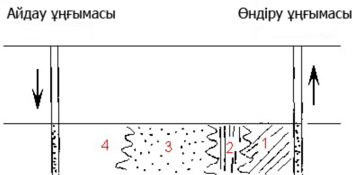
8.9-сурет. Қабатқа \text{CO}_2 айдау сұлбасы: 1 – қалдық мұнайы бар аймақ; 2 – мұнайдың жылжымалы шебі; 3 – \text{CO}_2 және судың аймағы; 4 – судың қысып шығарушы ағысы
