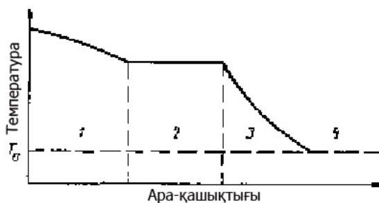
7.4-сурет. Қабатқа сулы буды айдағанда температуралар таралымының сұлбасы. Аймақтар: 1 – ысытылған бу; 2 – қаныққан бу; 3 – ыстық конденсат; 4 – суыған конденсат
