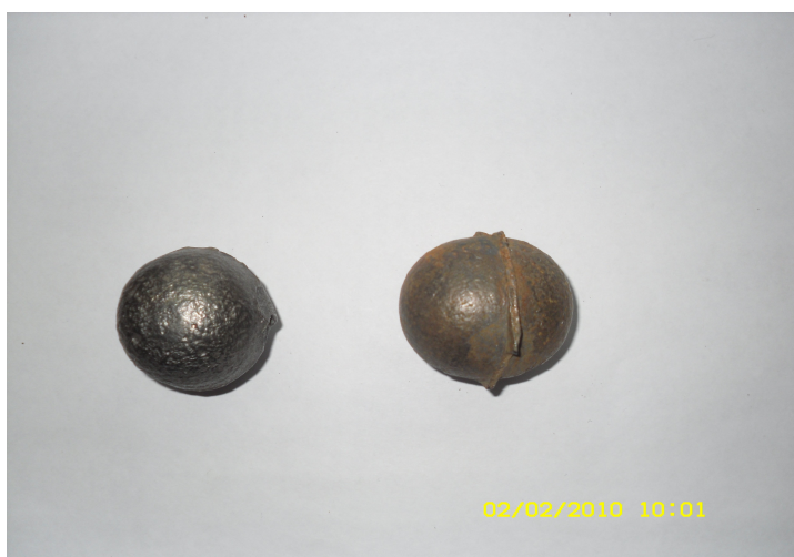
Рисунок 3 – Шары нормальной формы, но недостаточной твердости
