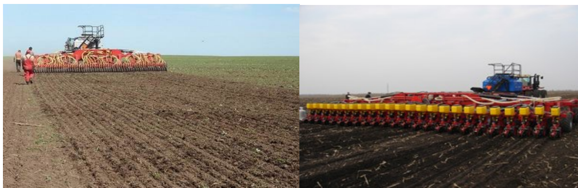
Рисунок 2 – Посевной комплекс «Терминатор» с высеваящими сошниками для зерновых культур (слева) и пропашных культур (справа)
