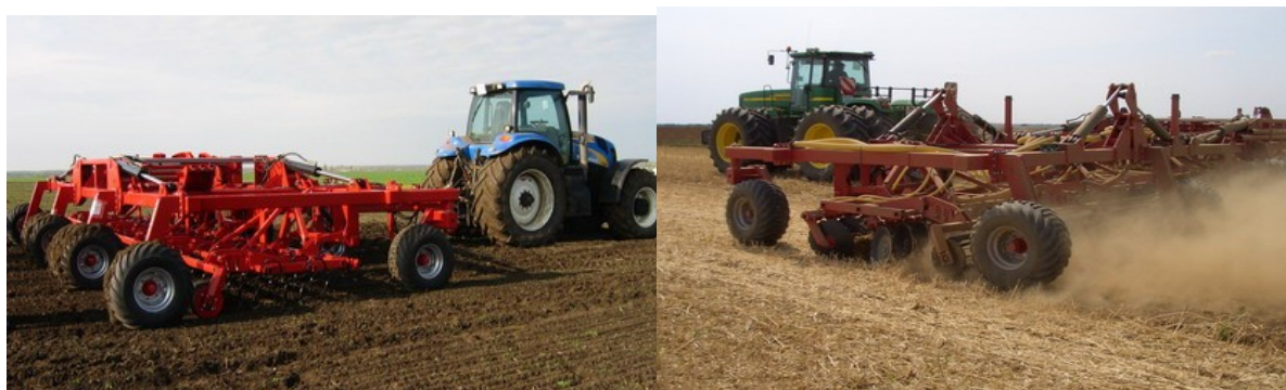
Рисунок 3 – Посевной комплекс «Терминатор» при обработке почвы с культиватором (слева) и дискатором (справа)
