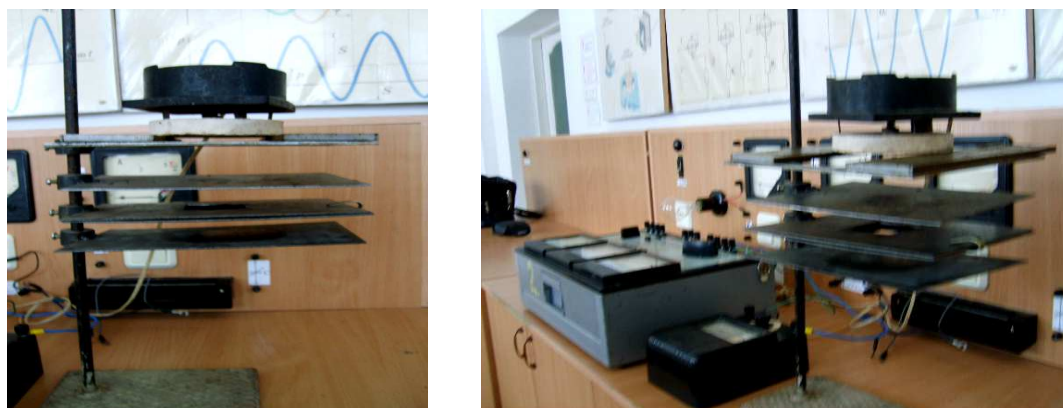
Рисунок 2 – Лабораторная установка по определению коэффициента чувствительности глины к сушке по экспресс-методу А. Ф. Чижского
