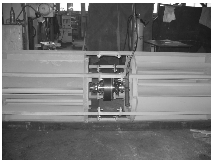
Генератор ВРТБ между модулями турбины
