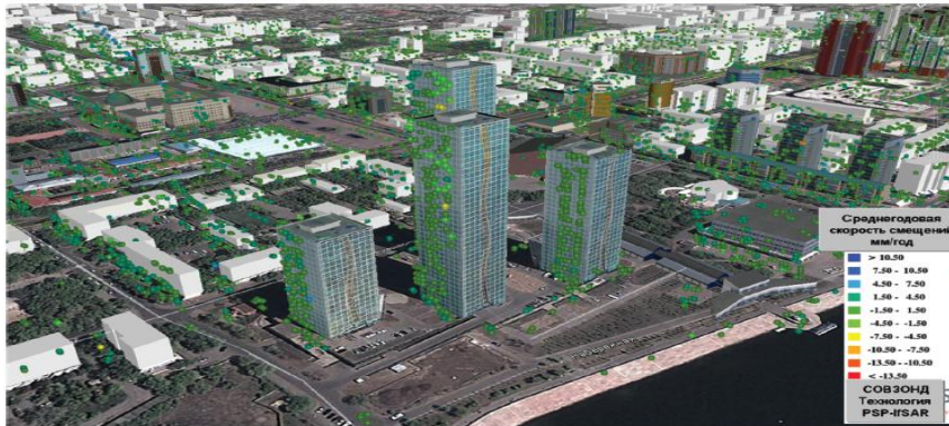
3-сурет. Желтоқсан және Рысқұлов көшелеріндегі «Гранд Алатау» тұрғын үй ғимаратында тұрақты шашыратқыштың үш өлшемді көрсетуі.
