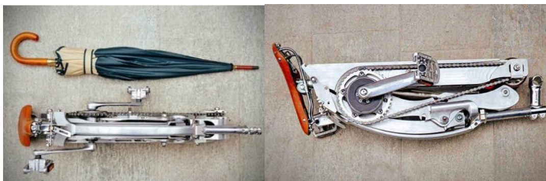
Рис. 4. Велосипед «Sada Collapsible Bike», складывающийся до размера мужского зонта.
