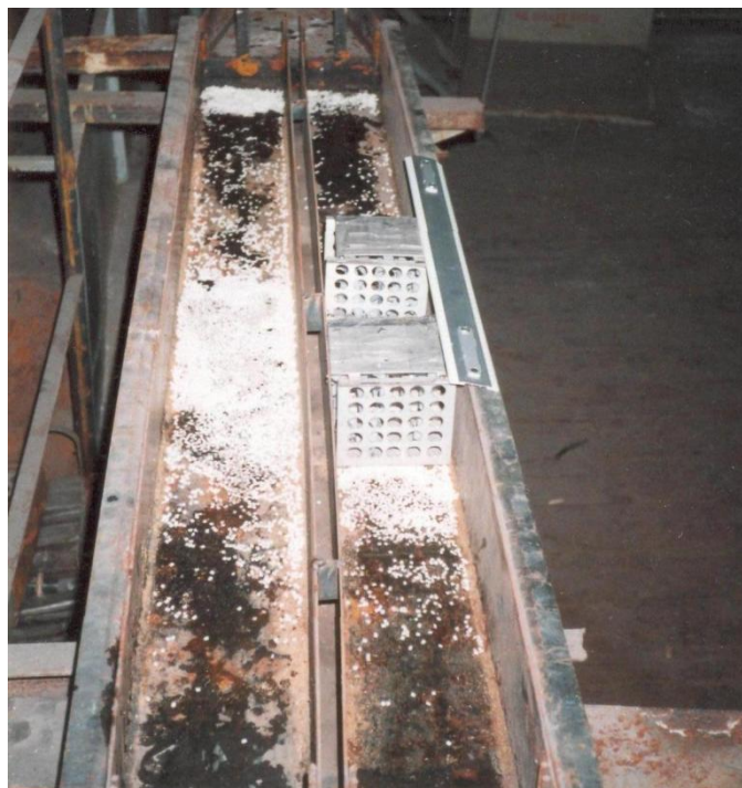
Рис. 7. Работа отстойника с кассетами и без них.
