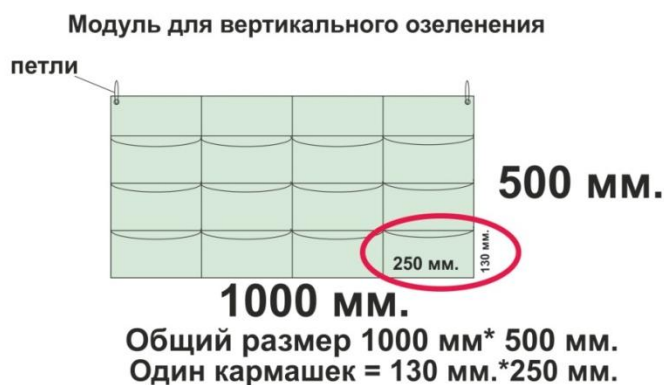
Рис. 3. Конструкция модуля производство РК. Автор Федянин А.В.
