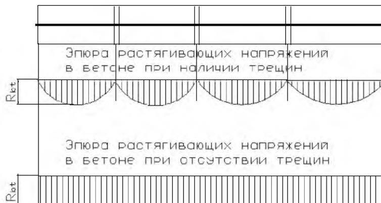
Рисунок 2 Эпюры растягивающих напряжений в бетоне для центрально растянутых элементов
