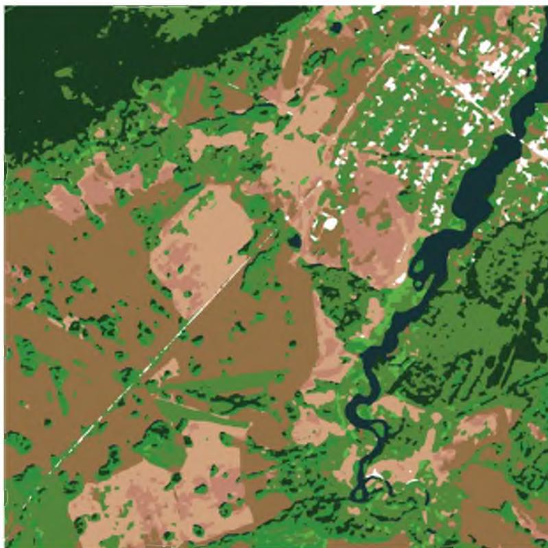
Рисунок 2 Результат применения скользящим окном процедуры выбора наиболее часто встречающегося класса
