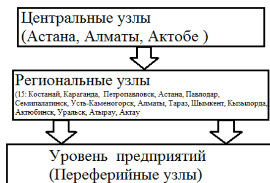
Рисунок 3 – Схема организации взаимодействия в сети передачи данных АО «НК КТЖ»
