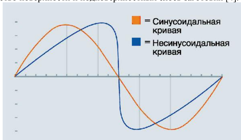
Рисунок 2 - Графики изменения скорости движения кристаллизатора для синусоидального и несинусоидального законов
