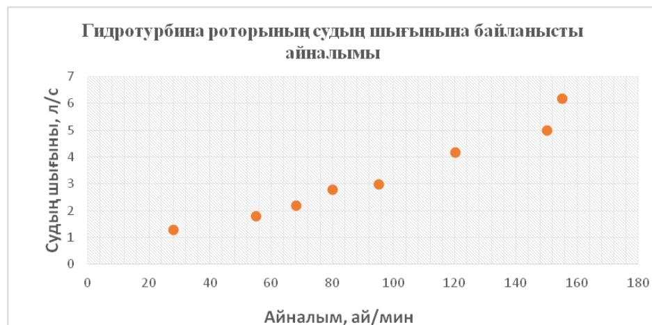
**14 сурет** – Гидротурбина роторының судың шығынына байланысты айналымы
