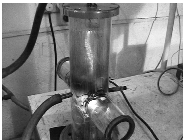
Рис. 1. Фотография горелочного устройства с тлеющим разрядом
