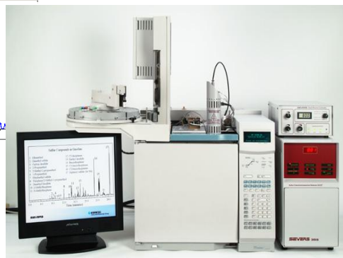
Рисунок 2. Газовый хроматограф Dual Plasma Agilent 6890N
