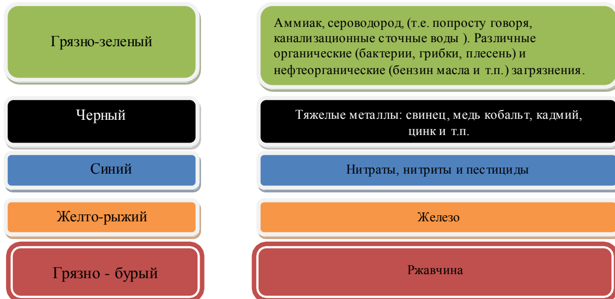
Рис - 1. Визуальное определение качества воды по цвету осадка
