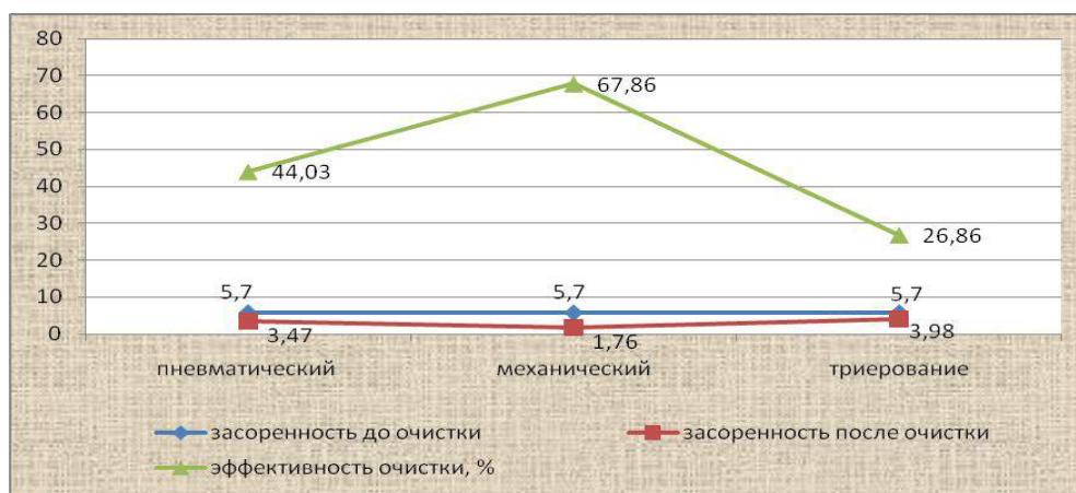
Рисунок 2 - Эффективность очистки семян льна в зависимости от способов очистки и засоренности исходного вороха
