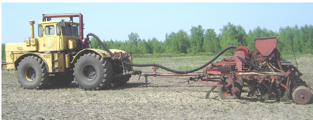
Рисунок 1 – Посевной агрегат с оборудованием для внесения выхлопных газов в почву
