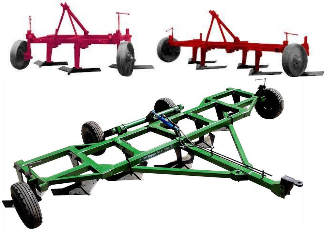
Рисунок 4 – Плоскорезы-глубокорыхлители
