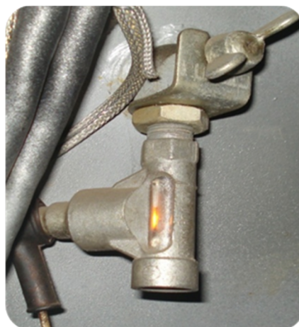
Фото 2 – Прибор контроля избыточного давления воздуха (прибор установлен на наклонном боковом листе корпуса бронетранспортёра справа от сидения командира боевой машины)
