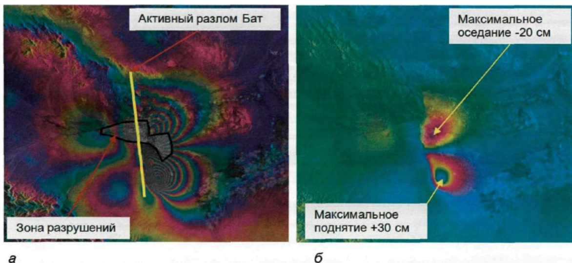
Рис. 1 (а) Результаты дифференциальной интерферометрической обработки радарных данных; а – дифференциальная интерферограмма; б – карта вертикальных смещений
