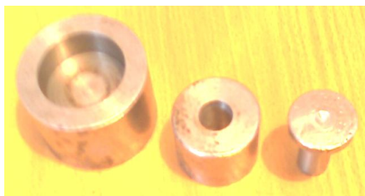
Рис. 3. Общий вид матрицы, цилиндра и поршня пресс-формы
