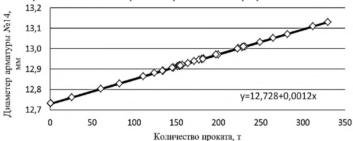
Рисунок 1. Изменение диаметра арматуры №14 в зависимости от количества проката на одном калибре валка
