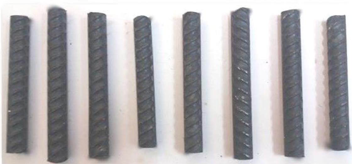
Рисунок 7. Полученные опытные образцы арматурного профиля №12
