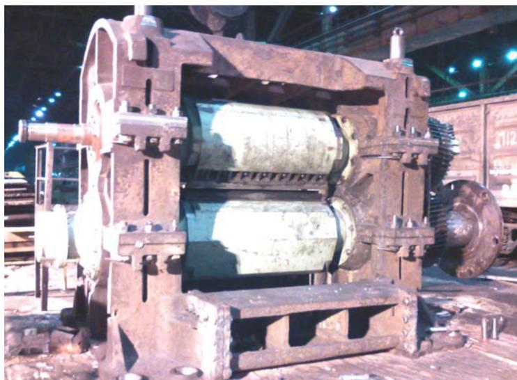
Рисунок 2. Барабанные летучие ножницы, установленные в НШГСП-1700 АО «АрселорМиттал Темиртау»
