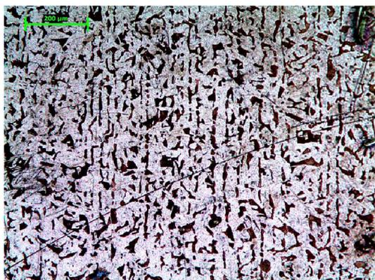
Рисунок 1. Микроструктура стали марки Ст3, Ф+П, 100<sup>x</sup>
