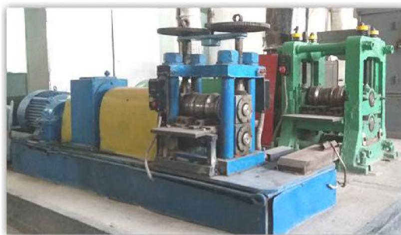
Рисунок 2. Общий вид полупромышленного прокатного стана «ДУО 200/150»,
