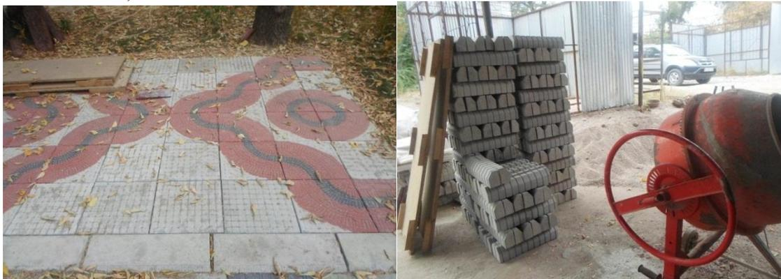
Рисунок 2 - Тротуарные и бордюрные плитки, изготовленные с использованием фильтрационного осадка сахарных заводов 2) – утеплительная плита (рисунок 3):
