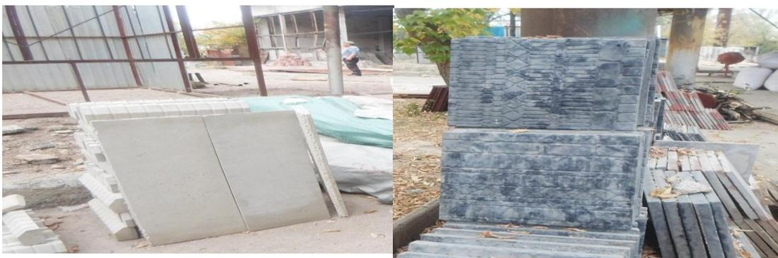
Рисунок 3- Утеплительные плитки, изготовленные с использованием ФО сахарных заводов
