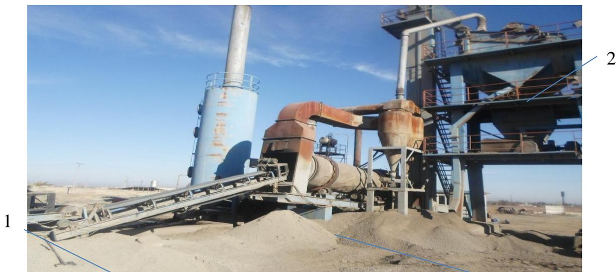
Рисунок 1-Технологическая линия для приготовления асфальтобетонных смесей: 1 - транспортер для подачи отсева или щебня в накопительный бункер; 2 - емкость для объемного дозирования; 3 - сушильно-смесительный агрегат.
