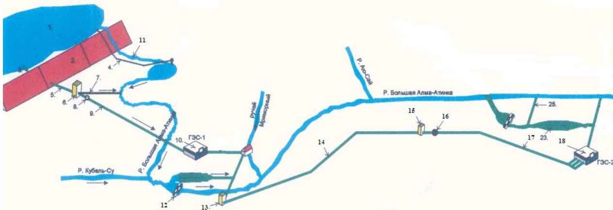
Рисунок 1- Общая схема ГТС и малых ГЭС-1 и ГЭС-2 каскада Алматинских ГЭС
