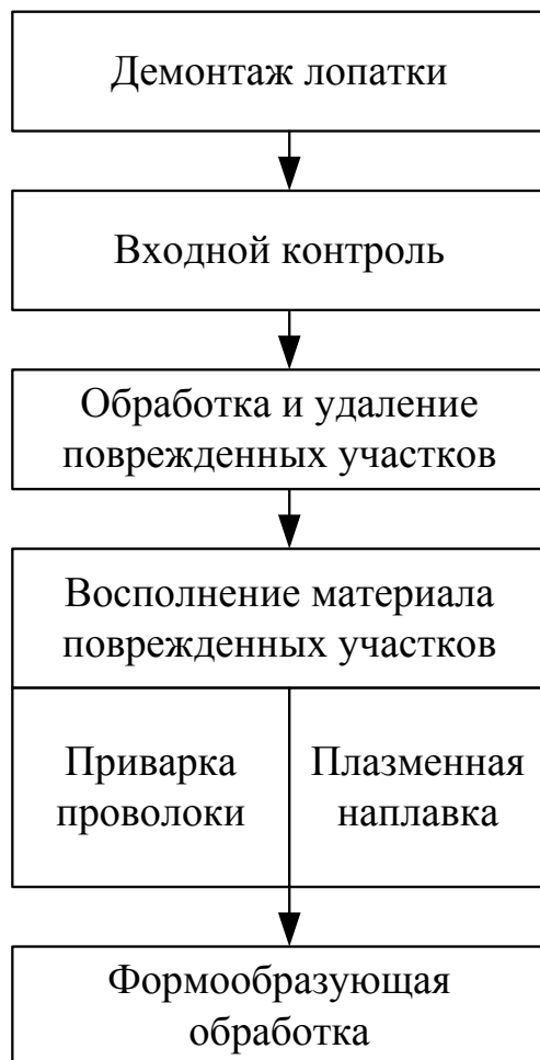
Рис. 1. Технологический процесс восстановления лопатки турбины
