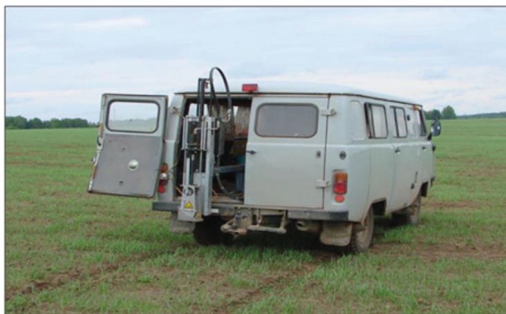
Рисунок 3 – Автоматизированный комплекс для агрохимического обследования почв на базе автомобиля марки УАЗ 3909
