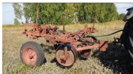
а) схема; б) вид сбоку Рисунок 2 – Лабораторная установка для определения основных параметров щелереза
