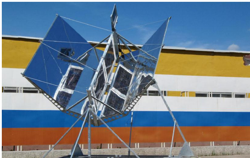
Рисунок 6 – Макет СЭУ 4000КД на двух солнечных модулях
