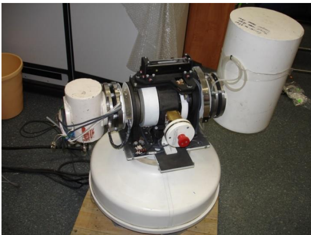
Программируемый привод телескопа в лаборатории прецизионного электропривода квантово-оптических систем
