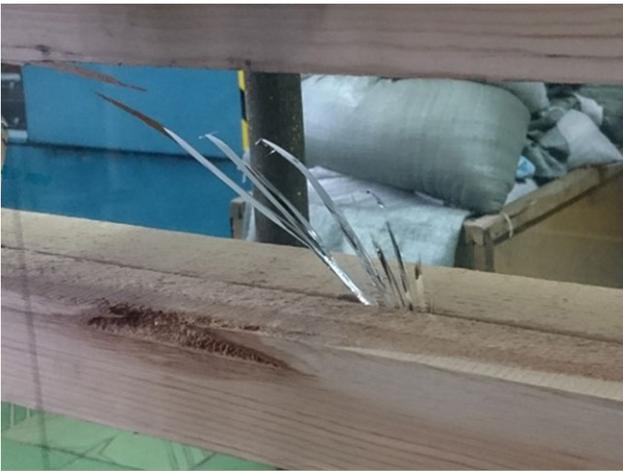
Рисунок 8 – Образование группы трещин
