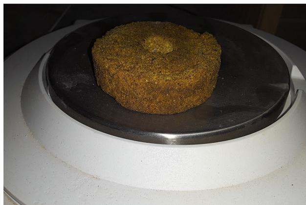
Рисунок 1 – Образец для испытаний на газопроницаемость
