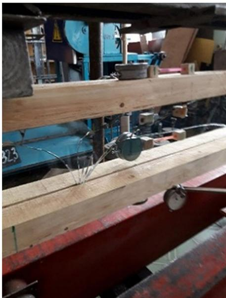
Рисунок 10 – Разрушение стенки балки СБ-3
