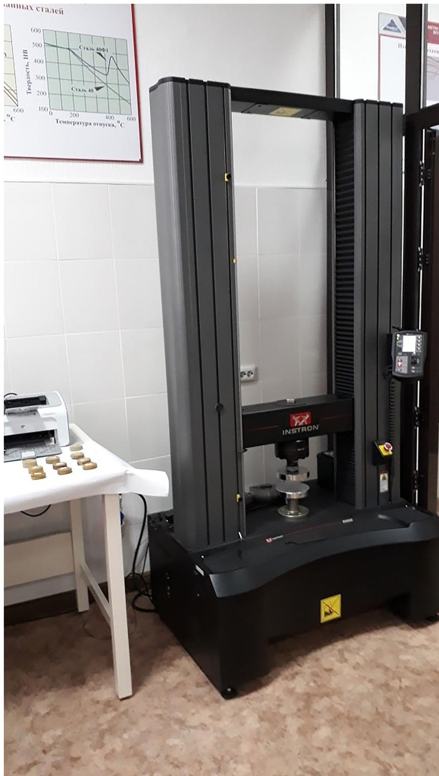
Рисунок 3 – Напольная установка Instron-100 для определения механических свойств
