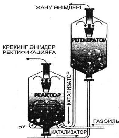
30-сурет. Каталитикалық крекинг қондырғысы
