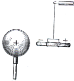
11.8.2-сызба. Диэлектрик таяқша электр өрісінде бұрылып, күш сызықтарының бойымен орналасады
