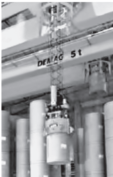
1.17-сурет. Вакуумды көтергіштері бар «DEAG» краны
