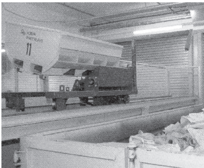
1.54-сурет. Пилотсыз басқарылатын «ашалы» арбамен қалдықтарды жинауға арналған контейнерге макулатураны автоматты түрде әкету
