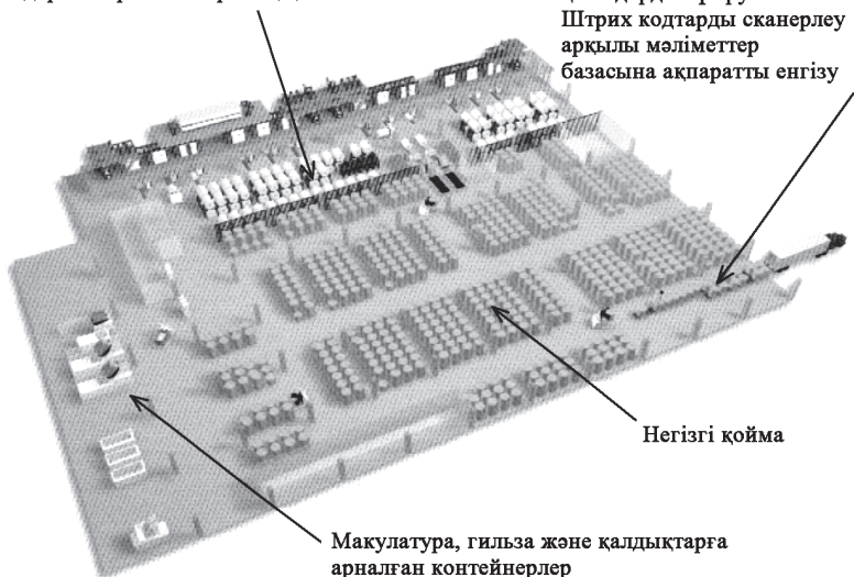
1.42-сурет. Негізгі автоматтандырылған аймақтары бар логистика жүйесі (бір дейгейлі вариант, EPC – түрі – Lokhen)
