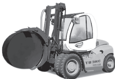
1.9-сурет. Әмбебап жапон өндірісіндегі рулондарды қысқыш (KOMATSU, Жапония):
