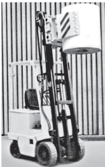
1.8-сурет. Жылдам ауыстырылатын жүк қармау құрылғылары бар тиегіш (TOYOTA, Жапония)
