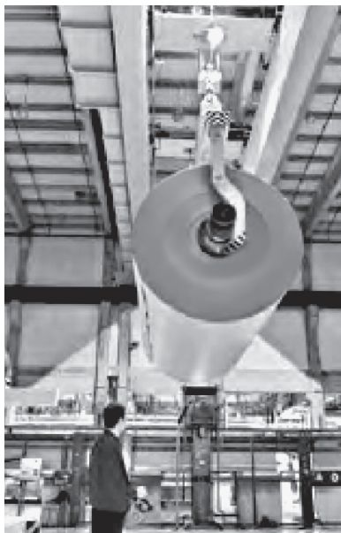
1.3-сурет. Тамбурлы арбаны қағазымен бірге көтеруге арналған траверсты, бұрылатын кран
