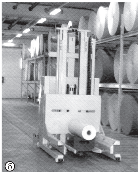
1.46-сурет. Жүктерді тасымалдауға арналған пилотсыз басқарылатын арбаларды қолдану:
