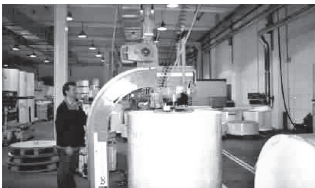
ә) Рулонды вакуум қармаушымен тік бағытта көтеру
