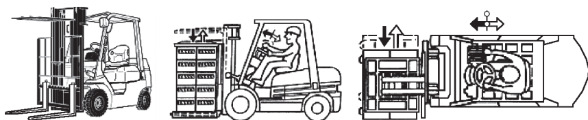
1.33-сурет. Жоғары жағынан қысу арқылы қармаушы құрылғылар бөтелкелер мен электр тауарларын, жүкті қораптарды шашылуудан қорғайды және сенімді тасымалдауды қамтамасыз етеді
