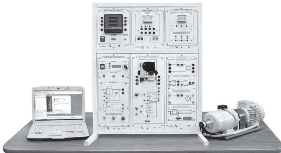
Рисунок 5 – Лабораторный комплекс «Частотнорегулируемый электропривод»
