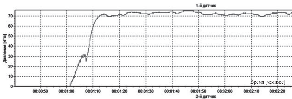
Рисунок 4 – Результаты экспериментальных исследований изменения давления в макете трубопровода
