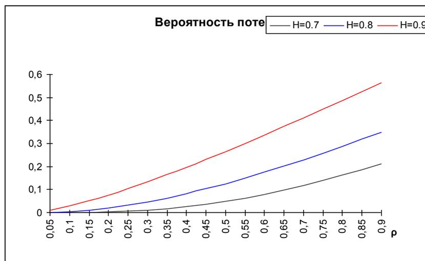
Рисунок 2 – Зависимость вероятности потерь кадров от загрузки с учетом значений показателя Херста
