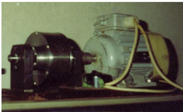
Рисунок 3 – Бесступенчато регулируемая передача. Действующий макет
