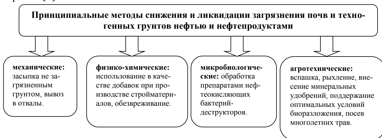
Рис. 2. Принципиальные методы снижения и ликвидации загрязнения почв и техногенных грунтов нефтью и нефтепродуктами
