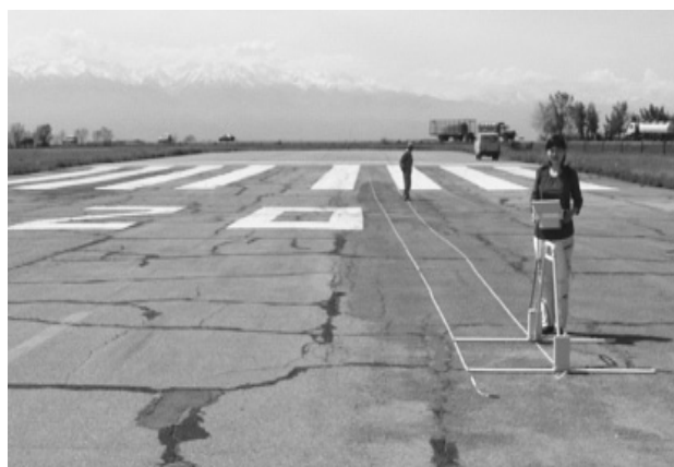
Рисунок 5. Взлетно-посадочная полоса и георадар (эксперимент 2)
