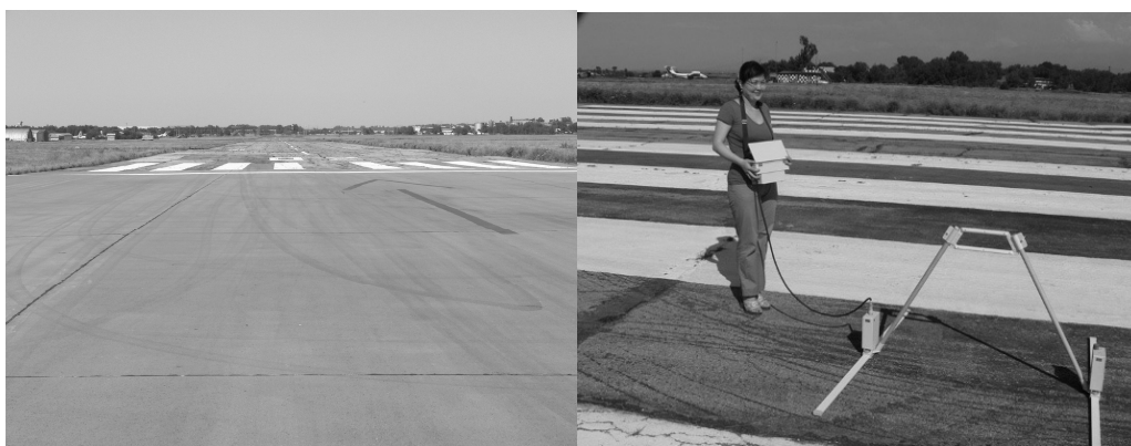
Рисунок 1. Взлетно-посадочная полоса и георадар
