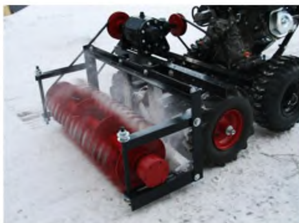
Рисунок 4 – Процесс разрушения снежно-ледяных образований
