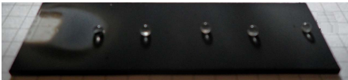
2-сурет – Шыны кварцты табақша бетіне күйе қабатын отырғызғандағы су тамшыларының тәртібі
