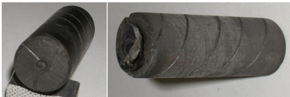
Рисунок 2 – Фотографии графитовой вставки катода плазмотрона до начала работы (слева) и с кратером депозита на торце электрода после окончания работы (справа)
