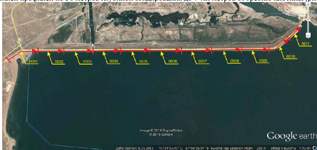
Рисунок 1 – Расположение георадарных профилей на Шардаринском гидрокомплексе.
