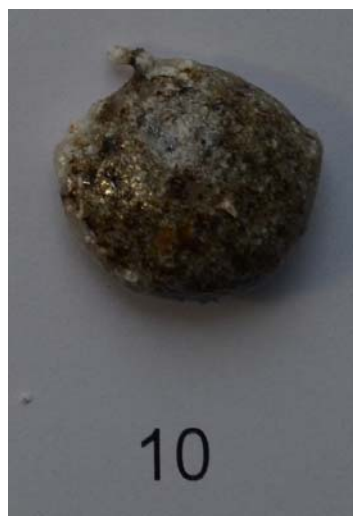
Рисунок 4 – Фотоиллюстрация (10) продукта обжига образца К-11-15 (гранит месторождения Корты, участок Жолпактас); температурно-хронологические параметры обжига каменного материала в условиях высокотемпературного нагрева – 1300°C (5', 40', 30')
