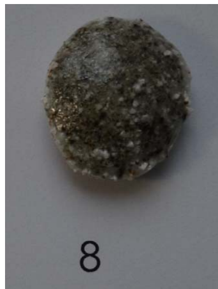
Рисунок 2 – Фотоиллюстрация (8) продукт обжига образца К-2-15 (гранит Кордайского месторождения); температурно-хронологические параметры обжига каменного материала в условиях высокотемпературного нагревания – 1300°C (5', 40', 30')
