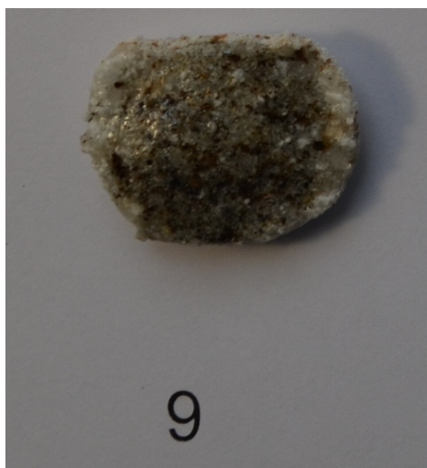
Рисунок 3 – Фотоиллюстрация (10) продукта обжига образца К-10-15 (гранит, месторождение Курты, участок Жарык); температурно-хронологические параметры обжига каменного материала в условиях высокотемпературного нагрева – 1300°C (5', 40', 30')
