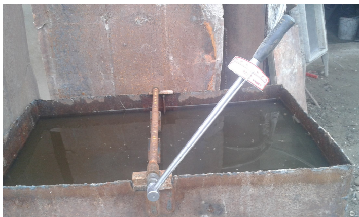
Сурет 2. Стандартты динамометрлі кілтпен білікті бұрау
