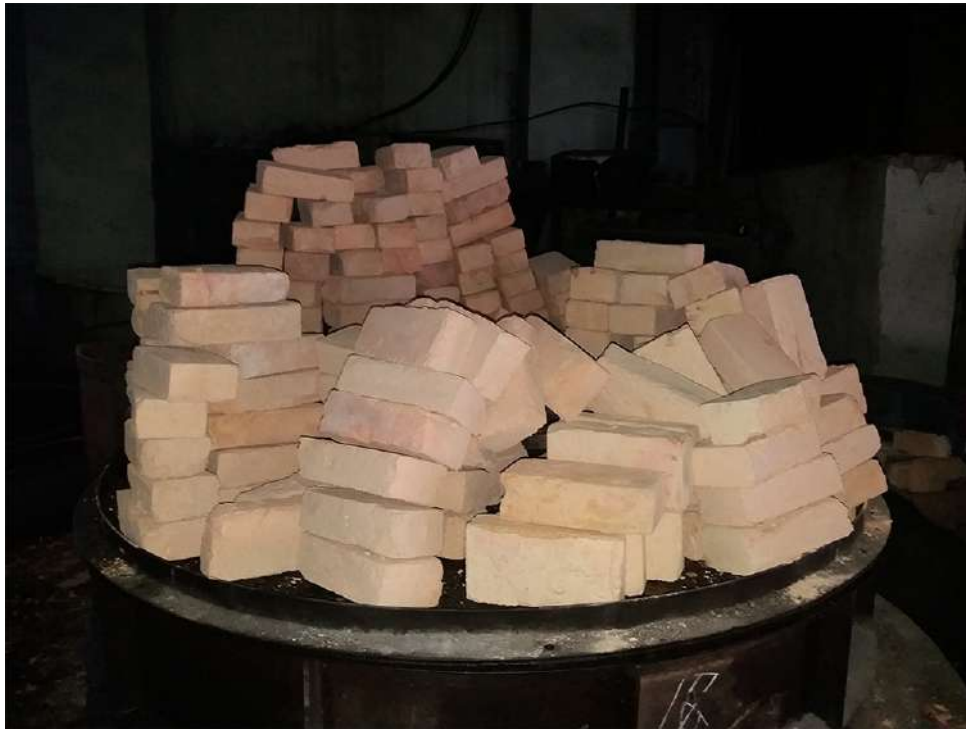
Рисунок 2 – Партия опытных шамотных кирпичей
