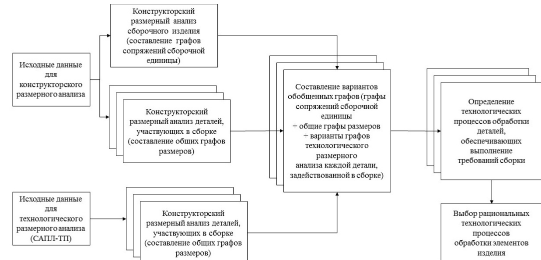
Рисунок 6 – Структура СТСТПМ, сформированная на основе связи между ТПП механообрабатывающего и сборочного производств
